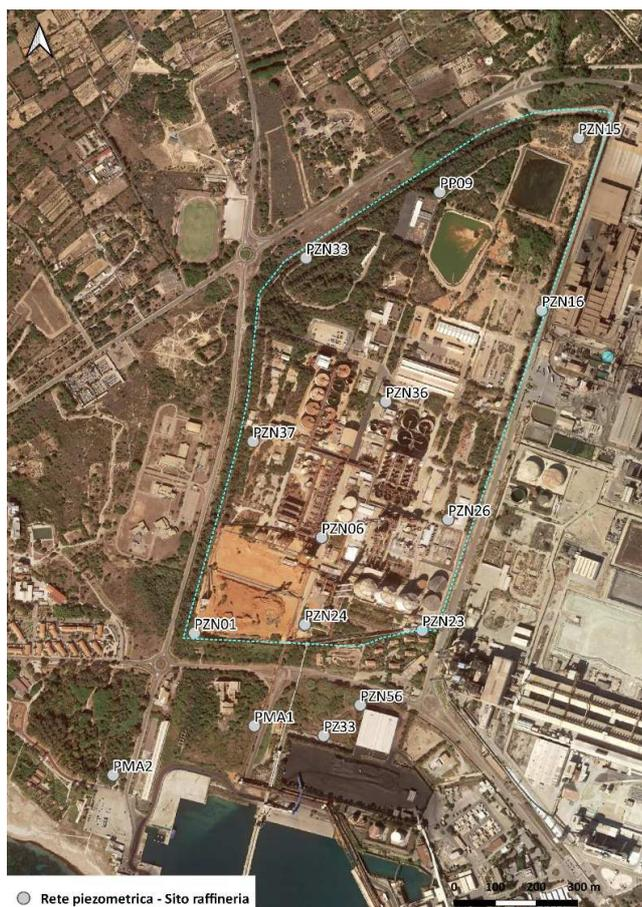
**Figura 4 – Rete monitoraggio falda stabilimento**
